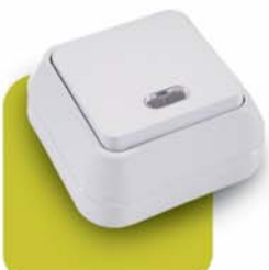
45121 Выключатель одноклавишный с подсветкой Напряжение 250 V Сила тока 10 A Степень защиты IP20 Размеры 69x69x34 mm
